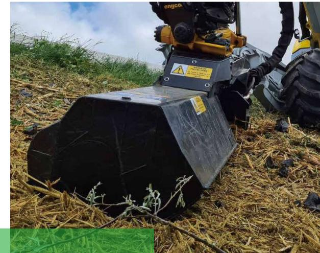
L'option Tilt offre une inclinaison jusqu'à 60°, véritable solution pour augmenter et limiter les projections, permettant de travailler avec précision sur des terrains inclinés ou irréguliers. Cette flexibilité rend l'accès aux zones difficiles plus simple et améliore l'efficacité de broyage sur tous types de reliefs.
