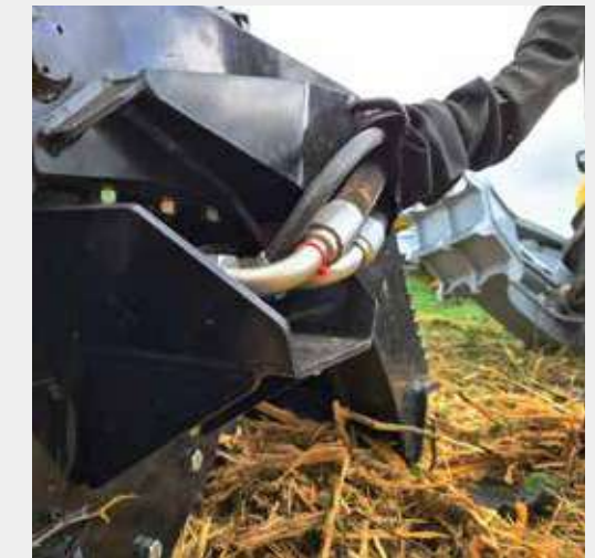
Protection des tuyaux
